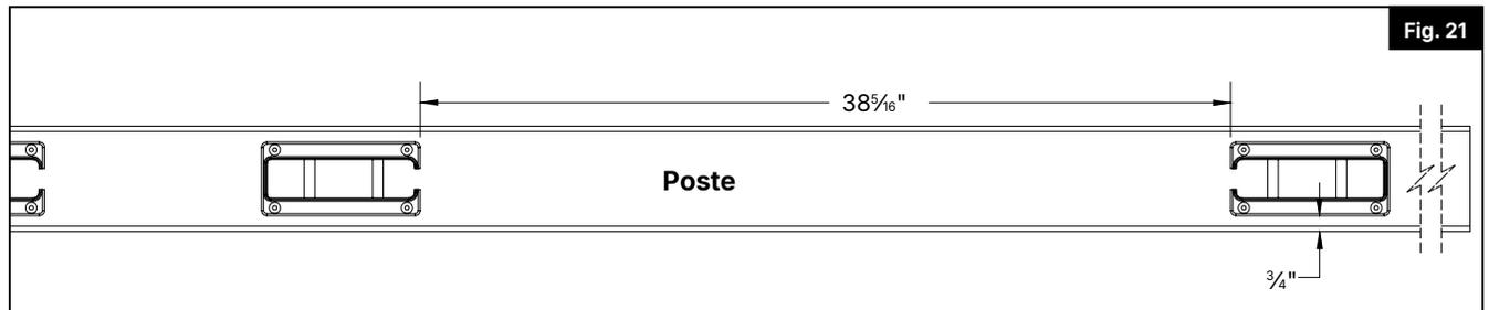
5. Coloque el canal del poste estructural acortado en la parte superior del soporte inferior y céntrelo en el poste. Taladre agujeros con una broca de  $\frac{1}{16}$ " y coloque los tornillos con el espaciado que se muestra (Fig. 22).
